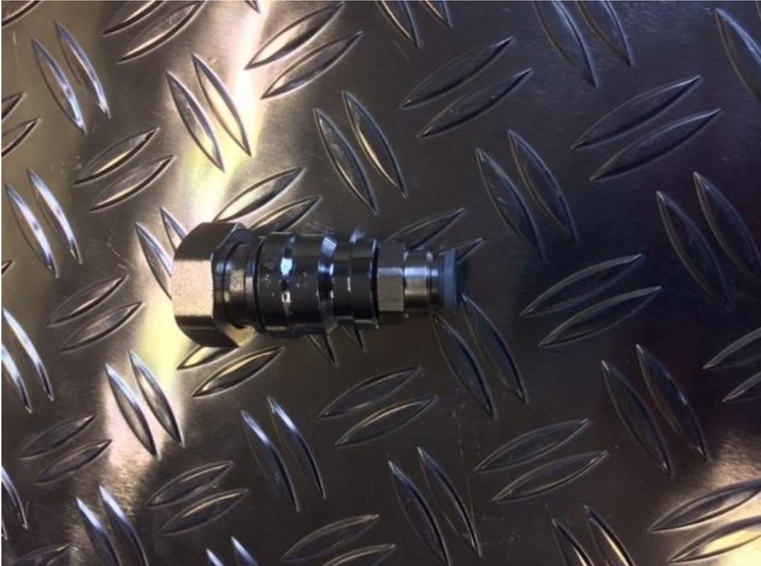
Durch „zurückziehen“ des grauen Ringes kann die Verbindung geöffnet werden. Durch die „Kralle“ bekommt das Rohr beim späteren Herausziehen in der Regel leichte „Riefen“.
